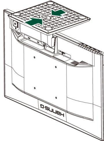
Figura 1. Instalar y desinstalar la base
