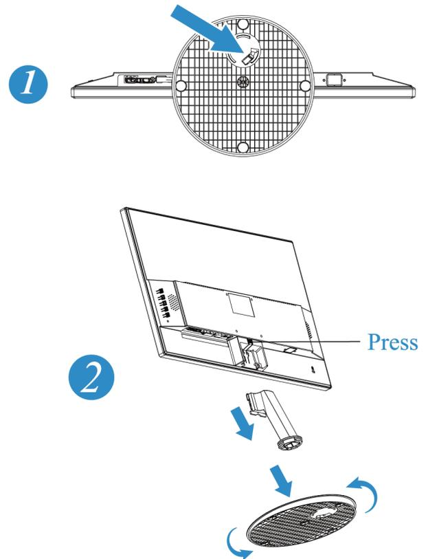
ABBILDUNG 1. INSTALLIEREN UND ENTFERNEN DES STÄNDERS
